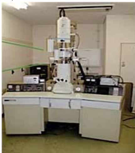
Σχήμα 1: Το Cryo-EM είναι ένα TEM (transmission electron microscope) με ειδικό χώρο δείγματος, ο οποίος επιτρέπει την παρατήρηση του παγωμένου ένυδρου δείγματος και διατηρεί θερμοκρασίες υγρού αζώτου ή υγρού ηλίου. (Royal Swedish Academy of Sciences)
